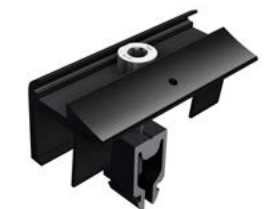
Endklemmen ohne Erdungspin für Rahmenhöhe 28 mm – 45 mm
