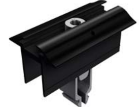
Mittelklemmen ohne Erdungspin für Rahmenhöhe 28 mm – 45 mm
